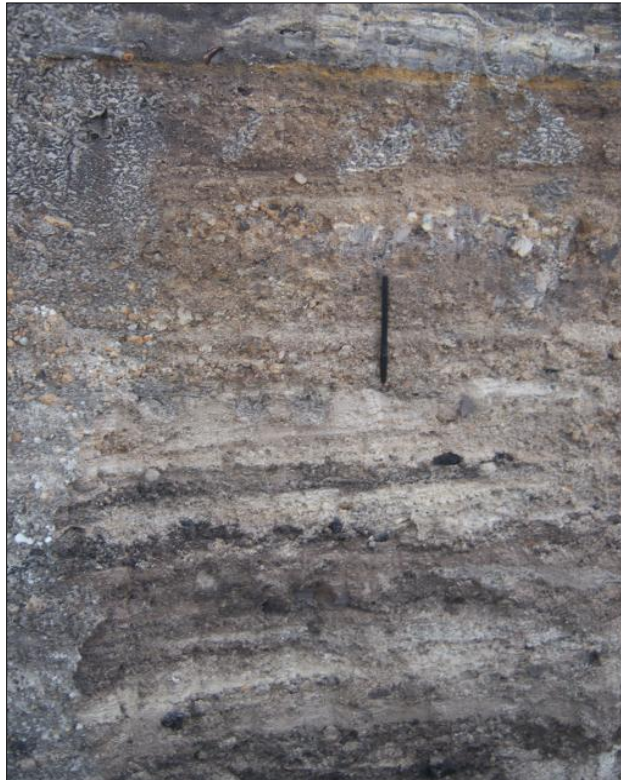
Gambar 8 Batupasir Sisipan Batulempung dengan Struktur Laminasi
