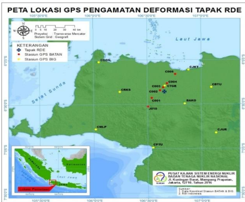
Gambar 4. Titik stasiun GPS berkala (merah) dan kontinyu (kuning), serta dugaan patahan (biru) [2].
