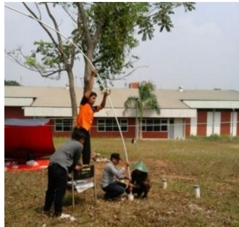
Gambar 5. Penyiapan larutan Rhodamin WT dan injeksi larutan Rhodamin WT ke dalam sumur bor utama SBU.
