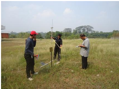
Gambar 4. Pengukuran kedalaman muka air tanah dan pengambilan sampel air sebelum injeksi rhodamin pada sumur bor penelitian.
