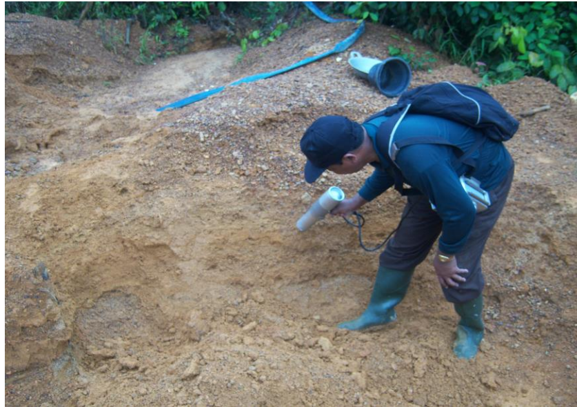
Gambar 5. Pengukuran radioaktivitas endapan aluvium pada lokasi Kbr 21
