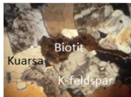
Gambar 13.c. Penampakan mikroskopis Granit Tempilang, terdapat struktur Pleokroik Halo pada biotit dan sebagian k-feldspar teralterasi berubah menjadi serisit.
