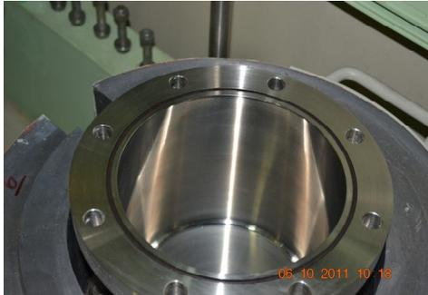
Gambar 7. vessel setelah dibersihkan
