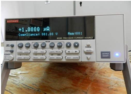
Gambar 7. pembangkit arus Keithley 6220
