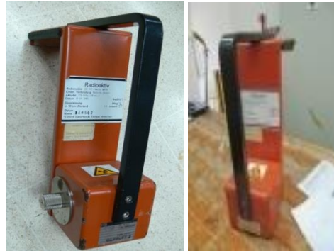
Gambar 4. Sumber standar Cs-137
