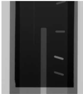
Gambar 7. Visualisasi cacat artifisial pada sampel Al (non-iradiasi)
