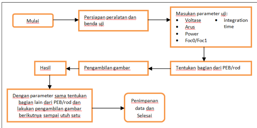
Gambar 10. Skema alur proses Radiografi Sinar-X untuk PEB [5]
