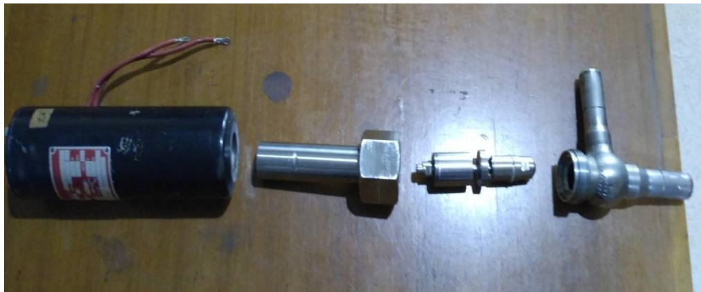
Gambar 3. Katup solenoid dan bagian-bagiannya.
