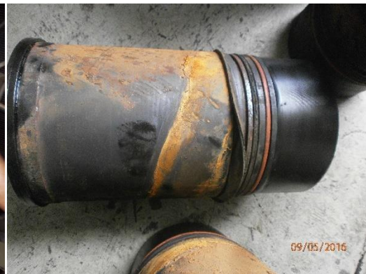
Gambar 4b: Linner korosi dan packing rusak
