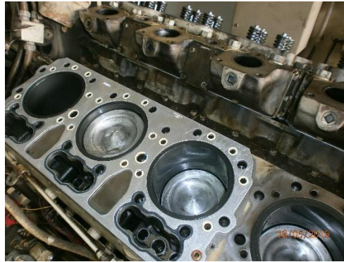
Gambar 5d: Piston dan liner terpasang
