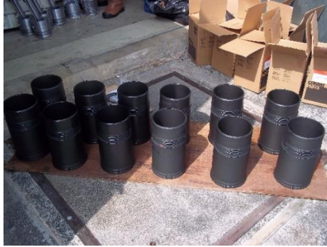
Gambar 5a: Cylinder head yg telah dibersihkan dan linner baru
