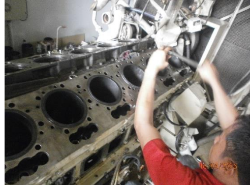
Gambar 5b: Pemasangan linner
