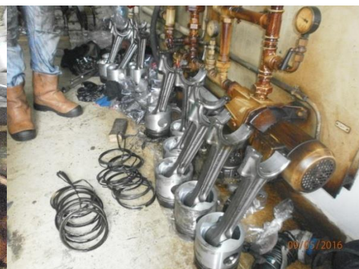
Gambar 4d: Batang piston menghitam dan o-ring sudah mengendor
