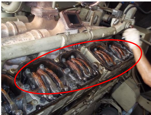
Gambar 4a: Rocker arm korosi
