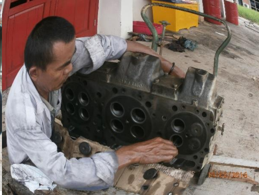
Gambar 4f: Lobang-lobang klep menghitam
