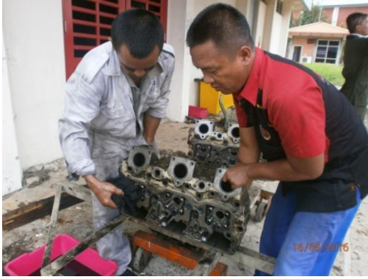
Gambar 4e: Menurunkan spring rocker arm untuk skir klep
