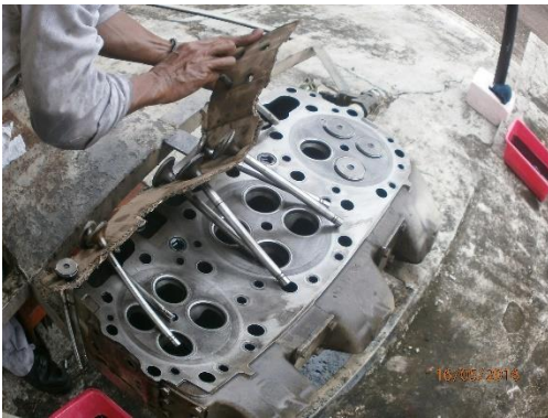
Gambar 5e: Lobang klep yg telah bersih
