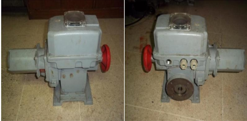
**Gambar 4.** Katup dan motor ventilasi udara buang
