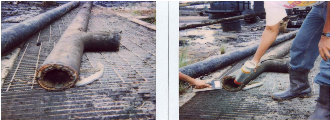
Gambar 5. TENORM Screening dalam pipa pada industri minyak bumi
