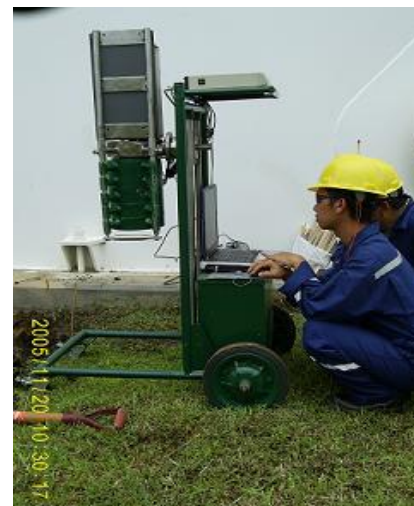
Gambar 4. Pengukuran kedalaman area yang terkontaminasi TENORM
