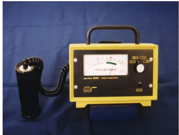
Gambar 10. Surveymeter alfa beta gamma Mini Monitor model 6000, Mini Instrument UK
