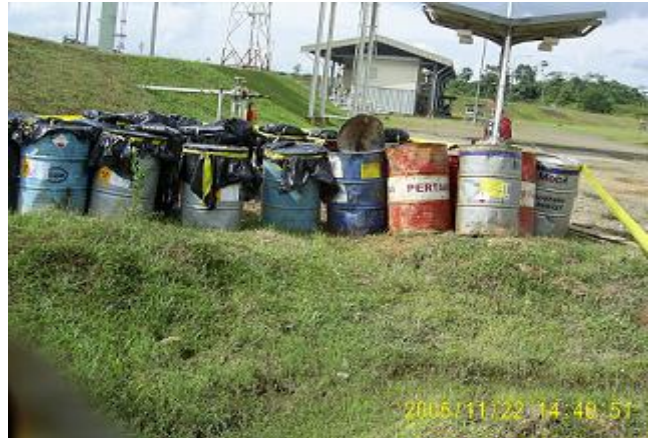
Gambar 2. TENORM di dalam drum setelah dekontaminasi
