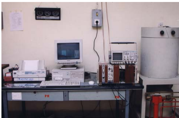
Gambar 9. Spektrometer gamma detektor HPGe model GEM-25185, E & G ORTEC - USA
