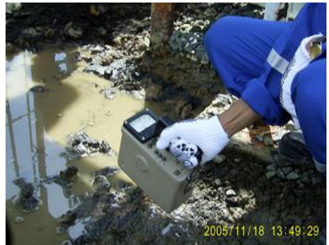
Gambar 3. Pengukuran area yang terkontaminasi TENORM
