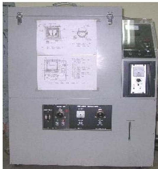
Gambar 2. Tampak luar kalorimeter untuk pengukuran radioaktivitas di P2RR BATAN
