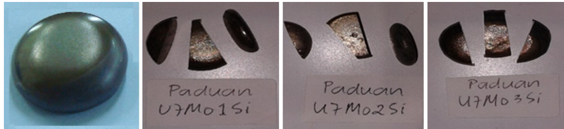
Gambar 4. Ingot paduan U-7Mo-xSi hasil proses peleburan dan potongannya
