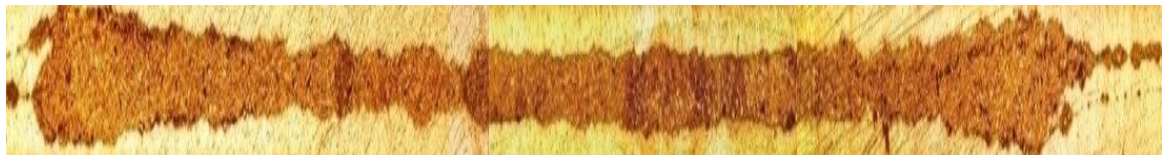
Gambar 12. Potongan PEB U-7Mo-1Si/Al
