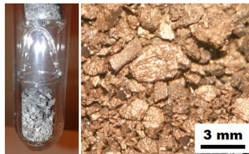
Gambar 7. Paduan U-7Mo-xSi hasil proses hidriding-dehidriding
