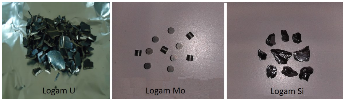
Gambar 3. Logam U, Mo dan Si sebagai bahan baku pembuatan paduan U-7Mo-xSi
