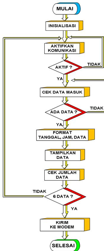
Gambar 6. Pemrograman untuk mengambil data dari mikrokontroler dan mengirim data ke komputer *server* melalui modem
