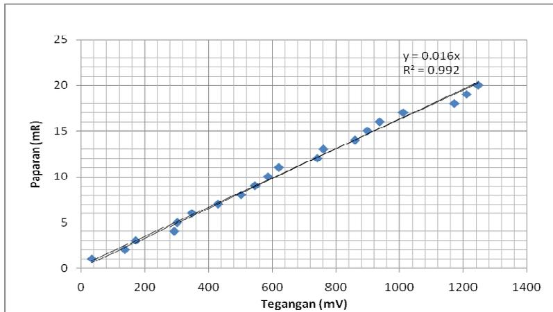
Gambar 5. Kalibrasi Paparan radiasi dengan Konversi Tegangan
