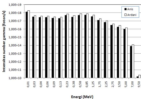
Gambar 5. Intensitas gamma peluruhan pada densitas UMo 8,30 g/cc
