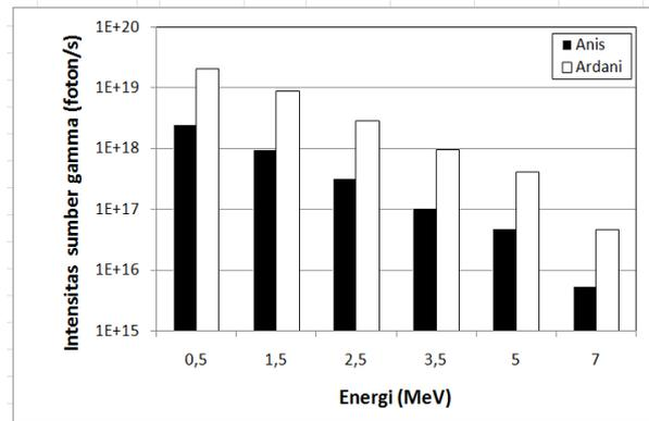
Gambar 4. Intensitas gamma fisi spontan pada densitas UMo 8,30 g/cc
