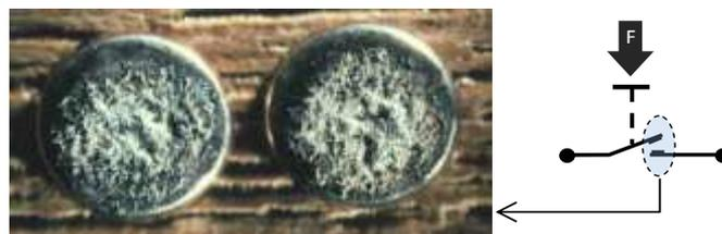
Gambar 2. Logam-kontak bagian-koneksi saklar<sup>[8]</sup>.
