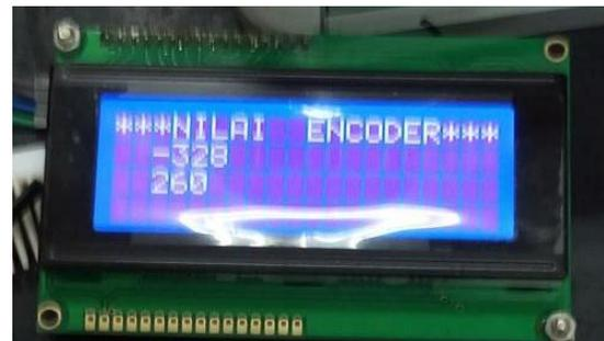
b. Contoh tampilan nilai *encoder* hasil uji dengan antarmuka LS7184N pada LCD20x4
