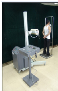
Gambar 4. Prototip Pesawat Sinar-X Diagnostik ( Litbang 2005-2006 )
