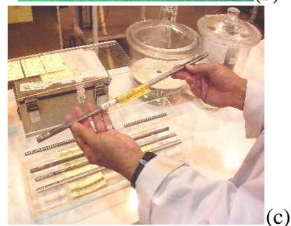
Gambar 6. (a) Komponen pendukung, (b) kelongsong, (c) pin bahan bakar uji dummy
