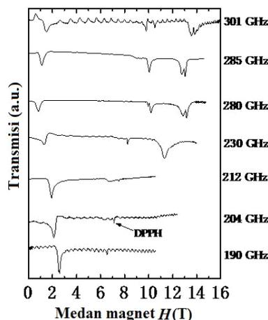
Gambar 3. Signal-signal *ESR* untuk  $MnF_2$  dan sampel standar *DPPH* sebagai fungsi intensitas medan magnet pada 4,2 K. Arah medan magnet sejajar sumbu  $c$  dari kristal tunggal  $MnF_2$ .
