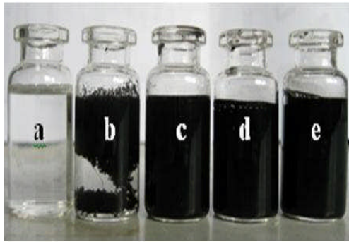
Gambar 1. Pengaruh sonikasi terhadap dispersitas MWCNT dalam larutan CTAB : (a). blanko, (b). sebelum sonikasi, (c). sonikasi 60 menit, (d). 90 menit dan (e). 120 menit
