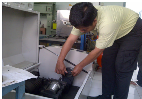
Gambar 1. Vial , bola dan fasilitas milling energi tinggi untuk proses penghalusan serbuk Fe, FeTb, FeDy dan FeCo
