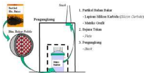
Gambar 3. Penghalang Produk Fisi Pada Teras Pebble Bed[7].
