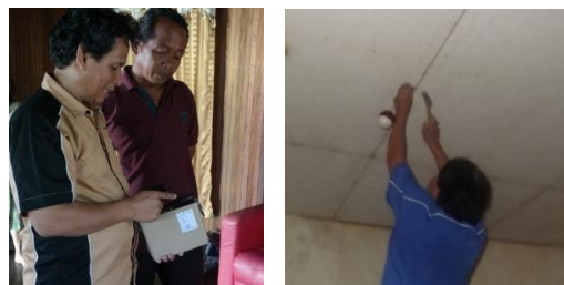
Gambar 3. Pengukuran laju paparan dosis radiasi gamma (kiri) dan pemasangan alat monitor radon pasif di dalam rumah penduduk (kanan)
