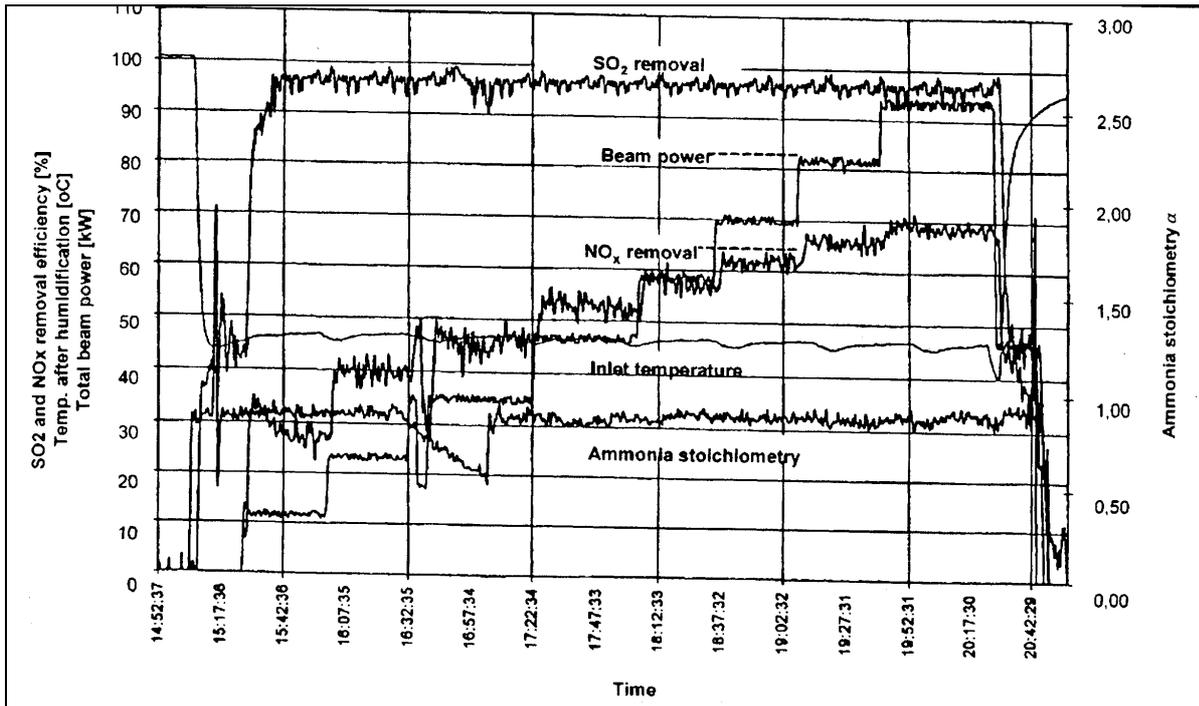
Gambar 7. Pengaruh daya berkas elektron terhadap *removal efficiency* SO<sub>2</sub> dan NO<sub>x</sub> pada suhu gas buang 45 °C [3].
