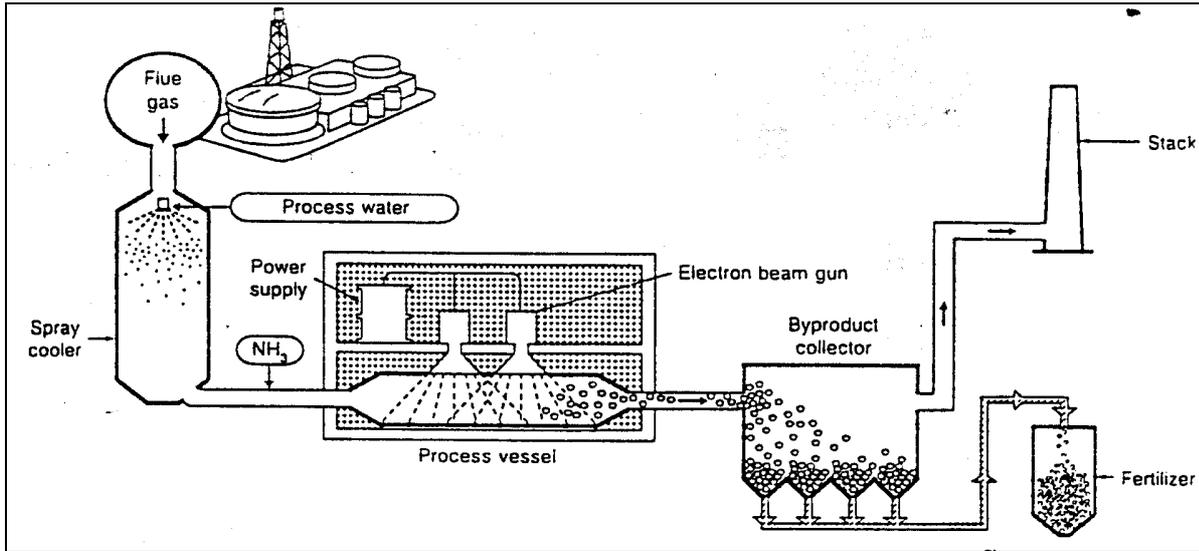
Gambar 1. Skema proses berkas elektron untuk pengolahan gas buang (2).
