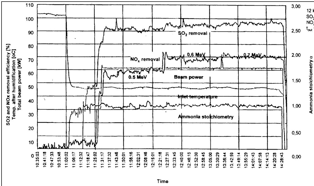
Gambar 8. *Removal efficiency* SO<sub>2</sub> dan NO<sub>x</sub> untuk beberapa nilai energi berkas elektron yang berbeda [3].
