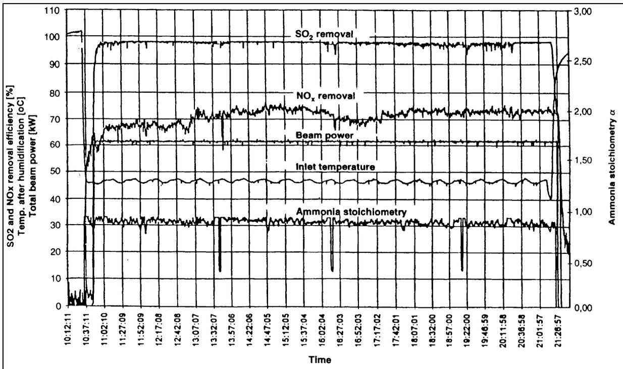
Gambar 6. Removal efficiency SO<sub>2</sub> dan NO<sub>x</sub> pada kondisi operasi suhu gas buang 45 °C dan daya berkas 60 kW<sup>[3]</sup>.
