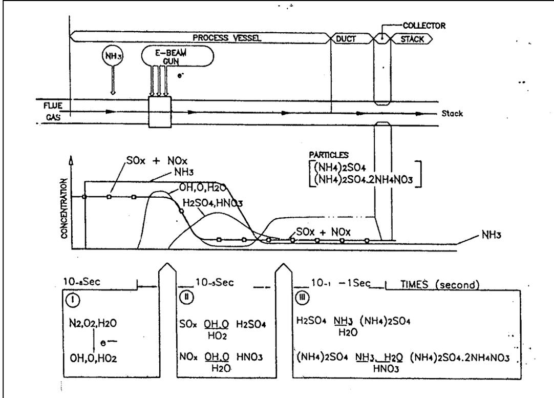
Gambar 2. Prinsip proses pengolahan gas buang dengan MBE
