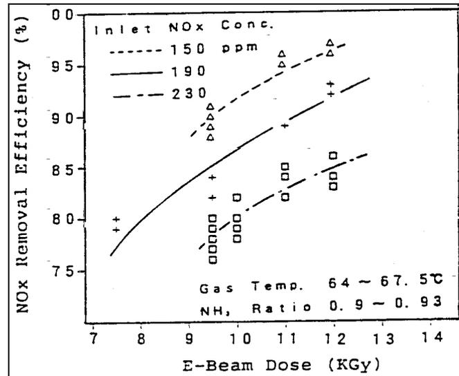
Gambar 4. Hubungan antara dosis *removal efficiency* NO<sub>x</sub> [4]
