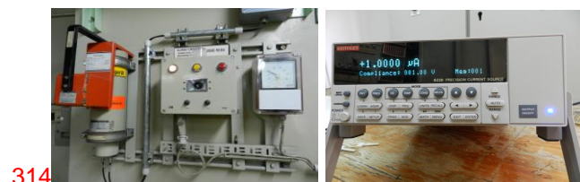
315 Gambar 6. Pengujian respon sistem pengukur 316 laju dosis menggunakan sumber 317 standar Cs-137 dan sumber arus
