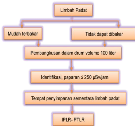
Gambar 5. Diagram pengumpulan limbah padat dalam gedung reaktor [7].
