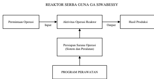
Gambar 1. Program perawatan pendukung operasi reaktor
